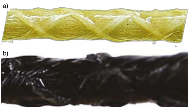
Rys. 1. Widok powierzchni prętów kompozytowych: a) GFRP (szkło), b) BFRP (bazalt)
