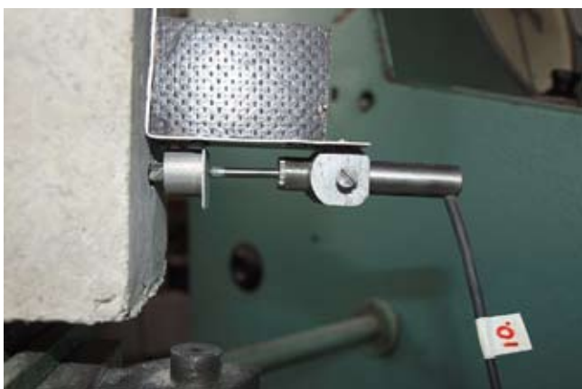
Rys. 5. Zamocowanie przetwornika przemieszczeń liniowych przy czole próbki
