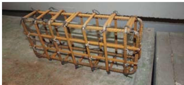
Rys. 2. Widok stalowego pomocniczego zbrojenia próbek umieszczanego w obu jej częściach
