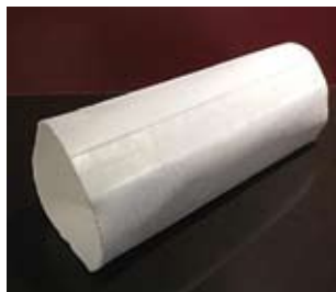
Rys. 9. Przykład rękawa przed jego nasączeniem żywicą [20]
