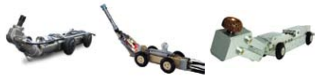
Rys. 7. Przykłady robotów kanalizacyjnych z różnymi rodzajami głowic [20]
