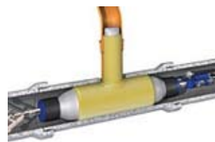
Rys. 29. Montaż kształtki kapeluszowej w przykanaliku [20]
