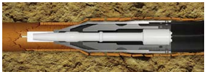
Rys. 25. Wciąganie głowicy kruszącej wraz nowym rurociągiem o większej średnicy do istniejącego rurociągu o mniejszej średnicy [20]
