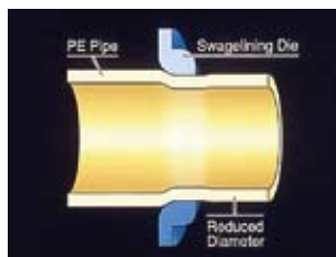
Rys. 18. Wprowadzanie wraz ze zmniejszeniem średnicy nowego rurociągu PE do rurociągu poddawane renowacji [20]
