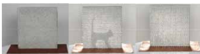
Rys. 19. Beton transparentny Kurpińskich [23]
