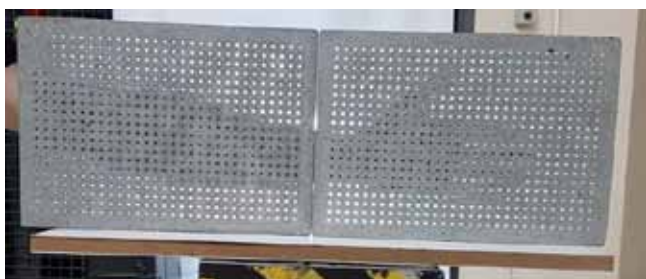
Rys. 20. Płyty z betonu transparentnego: po prawej pręty borokrzemowe, po lewej pręty PMMA [24]
