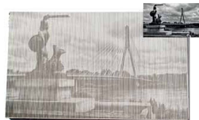
Rys. 9. Betonowy element wykonany w technologii fotobetonu z panoramą Warszawy wraz z odwzorowanym zdjęciem; źródło: fotografia własna
