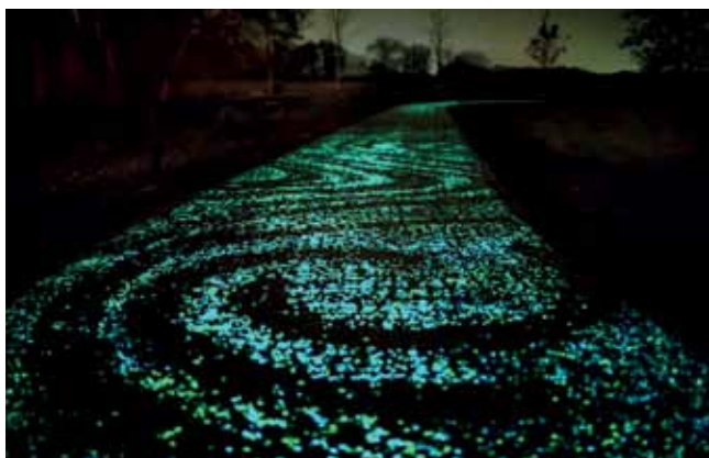
Rys. 23. „Van Gogh Bicycle Path” w Holandii z kruszywem luminescencyjnym ułożonym we wzór inspirowany twórczością malarza [25]
