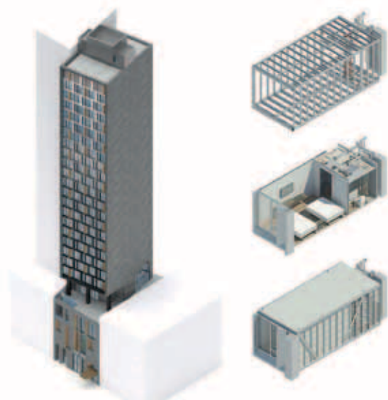
Rys. 3. Wizualizacja najwyższego budynku hotelowego zaprojektowanego przez Danny Forster & Architecture w systemie budownictwa modułowego, przewidywany czas montażu – 90 dni (źródło: dmdmodular.com.)
