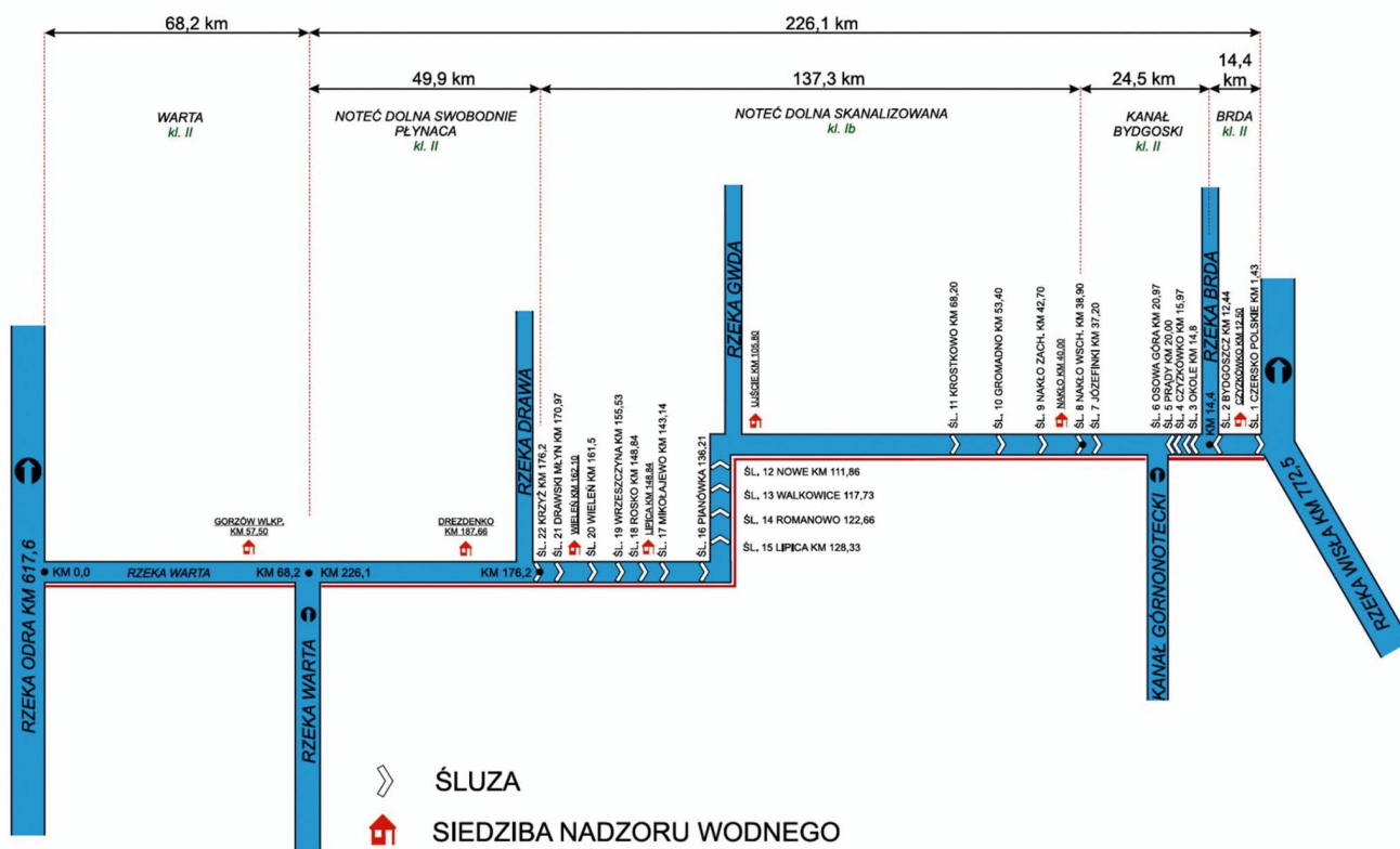
Rys. 2. Schemat drogi wodnej Wisła-Odra. Uwaga: Stara Noteć wpada do Noteci Skanalizowanej poniżej śluzy Nakło Wschód [1]
