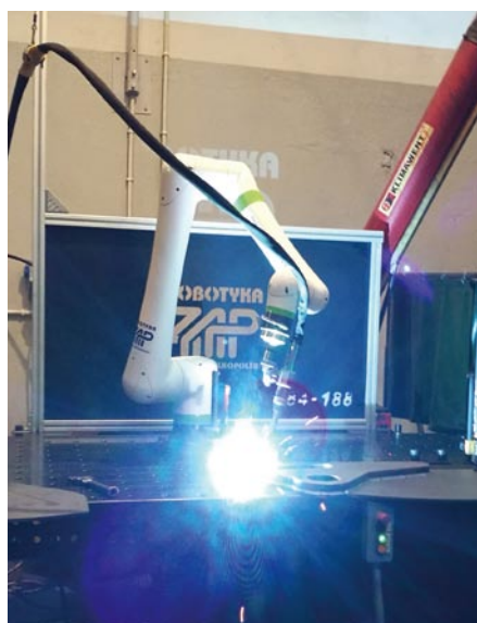
Cobot do spawania seryjnego małogabarytowych elementów
