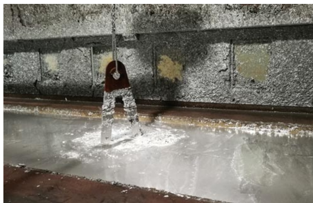
Cynkowanie ogniowe elementów
