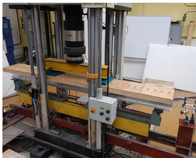
Rys. 6. Belka zespolona aluminiowo-drewniana ze śrubami podczas badań [5]
