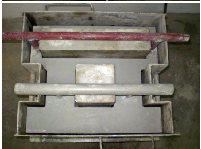
Rys. 1. Stanowisko do produkcji ekologicznych pustaków
