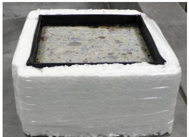
Rys. 2. Przygotowana próbka betonu wałowanego przed badaniem mrozoodporności [3]
